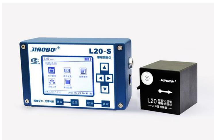
本次监测采用成都交博科技有限公司生产的 L20-S 智能爆破测振仪，该仪器的优点在于质量轻、可防水、防尘、耐压抗击、精度高、应用面广等特点，成熟、稳定、易用、便携。L20-S 智能爆破测振仪可以在现场通过按键和液晶屏快速设置参数，从而达到信号快速、准确采集的目的。同时，仪器可以在现场通过仪器本身的功能读出特征值，还能大致预览到已经采集到的信号波形。仪器采用自适应量程，采集时无须做量程调整。时间可单独设置，可根据实际需要设置采集时间。根据实际情况也可以现场对采集做调整。
